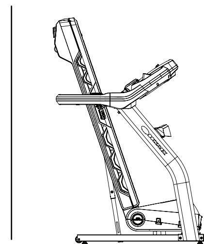
6. Правой рукой нажмите и удерживайте в нижнем положении кнопку освобождения беговой платформы. Используя подъемную рукоятку, располагающуюся под задней поверхностью бегового полотна, поднимите беговую платформу вверх до максимально досягаемого положения и активируйте гидравлический подъемник. Как только беговая платформа переместится приблизительно на 10 дюймов (25,4 см), можно отпустить кнопку освобождения беговой платформы. Проверьте надежность фиксации гидравлического подъемника на месте.
