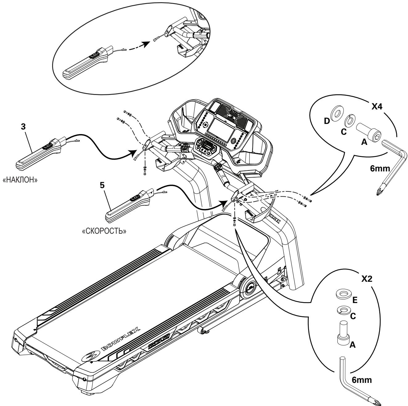
**7. Защелкните верхние и нижние крышки узла соединения на своих местах и зафиксируйте их на раме в сборе с помощью крепежных средств**
