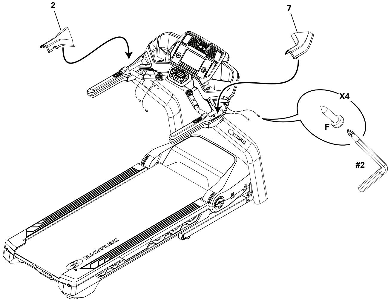
**8. Затяните все крепежные средства, установленные на предыдущих шагах, и прикрепите лоток поперечины к раме в сборе**
