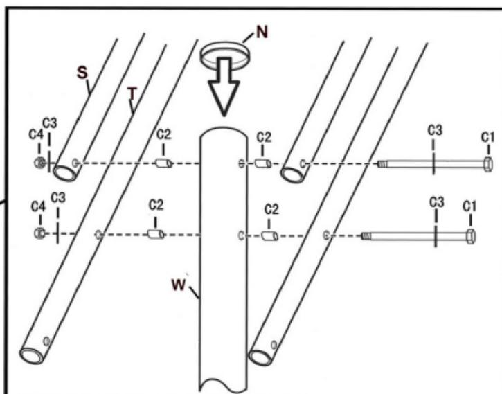
Установите подпорки щита (S), (T), колпачок стойки (N) и механизм регулировки (Z), как показано на рисунке, а затем затяните все гайки.
