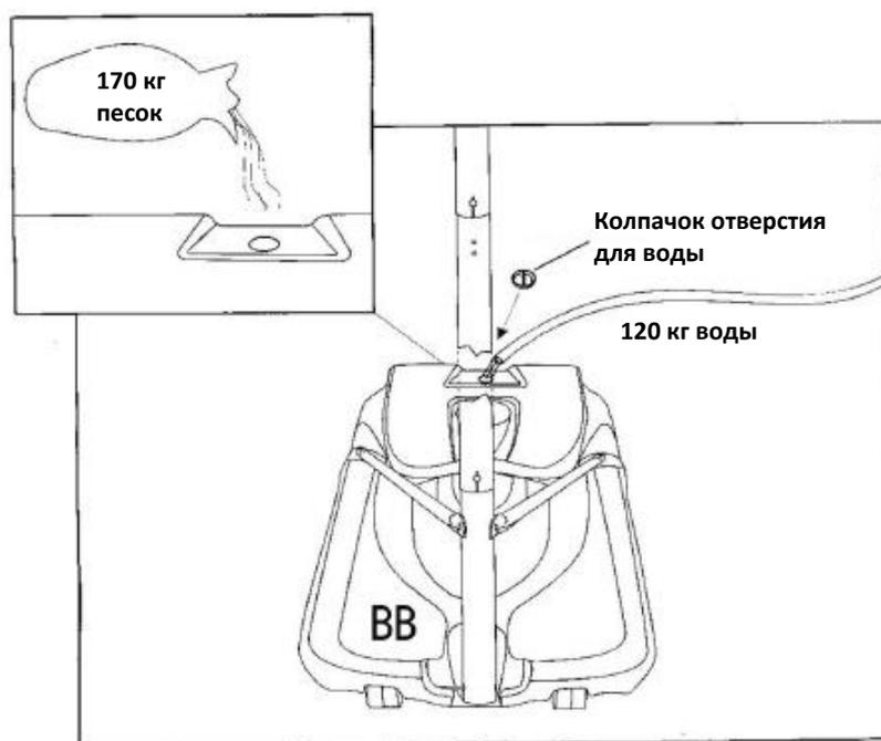
В целях безопасности рекомендуется заполнять емкость основания песком, а не водой. При возникновении даже небольшой протечки вода может вытекать незаметно, из-за чего система может упасть и нанести травмы и/или привести к смерти и порче имущества. Устанавливайте основание только на ровной поверхности, вдали от острых предметов, которые могут ее проколоть.
