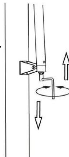
Ручку (R) можно снять или хранить, достав маленький болт (Z1) в конце механизма регулировки (Z)
