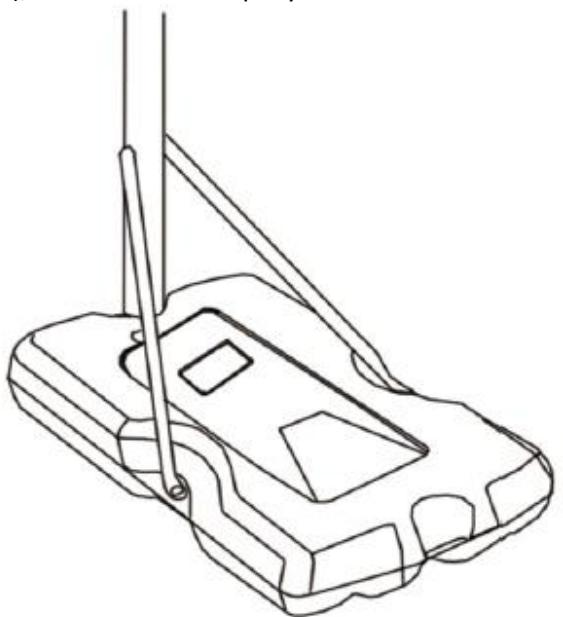
Закрепите другой конец подпорки стойки (L1) и (L2) с двух сторон на основании (S) с помощью болтов (C1), (C2) и (C3), как показано на рисунке.
