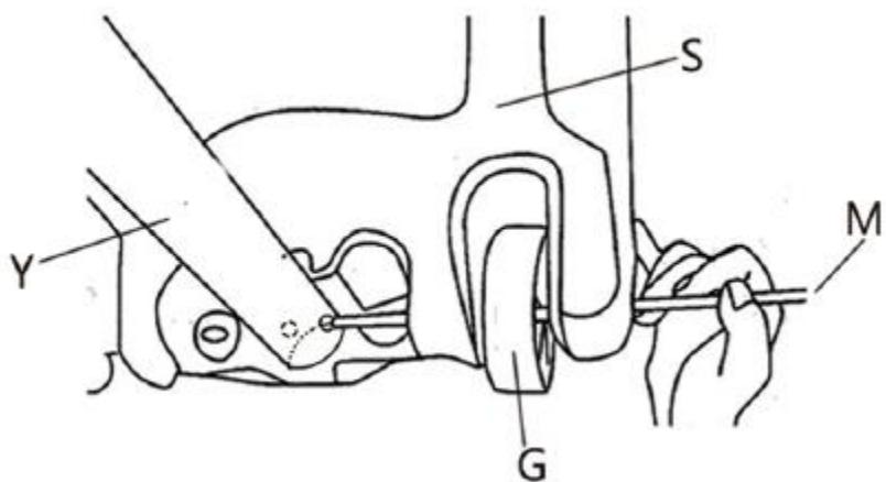
Вставьте шток колеса (M) в колесико (G), основание (S) и нижнюю секцию стойки (Y), как показано на рисунке.
