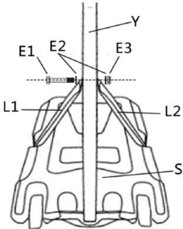
Закрепите один конец подпорки стойки (L1) и (L2) на нижней секции стойки (Y) с помощью болтов (E1), (E2) и (E3), как показано на рисунке.
