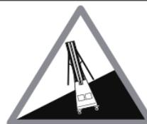
**БУДЬТЕ ОСТОРОЖНЫ ПРИ ПЕРЕМЕЩЕНИИ СТОЛА ПО НАКЛОННОЙ ПОВЕРХНОСТИ**
