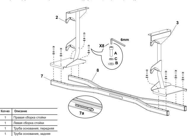
**Примечание.** Крепежные изделия для выполнения этого шага входят в комплект крепежных изделий для стойки 2080. Полностью затяните крепежные изделия. Поверните основание в сборе кверху и настройте ножки регулятора уровня таким образом, чтобы сборка была выровнена и устойчива.
