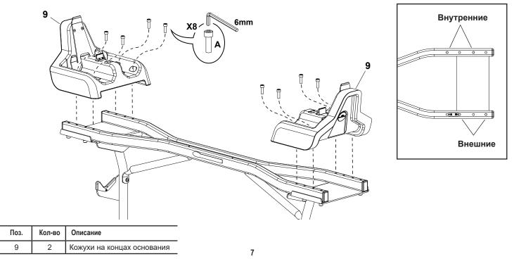
Примечание. Крепежные изделия для выполнения этого шага входят в комплект крепежных изделий для прямой и изогнутой штанг 2080 (а не в комплект крепежных изделий для стойки 2080). Убедитесь в правильной ориентации переходных пластин. Винты должны зайти в отверстия фасок с обратной стороны пластин.
