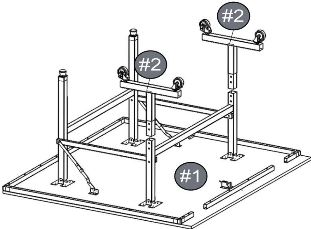
**ШАГ 3:** Закрепите Т-образные ножки (Р2) с помощью винтовой группы (Р4), как показано на рисунке. Убедитесь, что винты и болты надежно затянуты, после чего осторожно переверните стол. Отрегулируйте ножки и колесики таким образом, чтобы создать ровную игровую поверхность.
