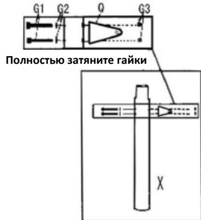
Сопоставьте отверстие в нижней части среднего сегмента стойки с отверстием в верхней части нижнего сегмента стойки
